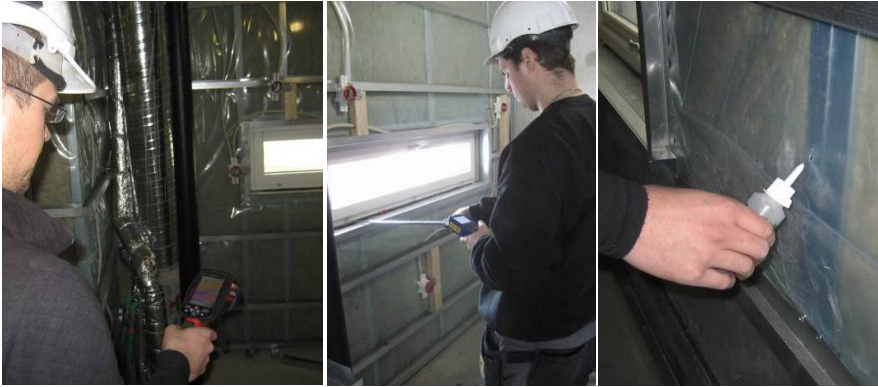
Figur 3 Läckagesökning med värmekamera, lufthastighetsmätare och rökgas.
